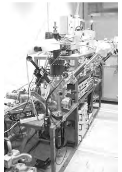
La production de diamant par Dépôt Chimique à partir d'une phase Vapeur
